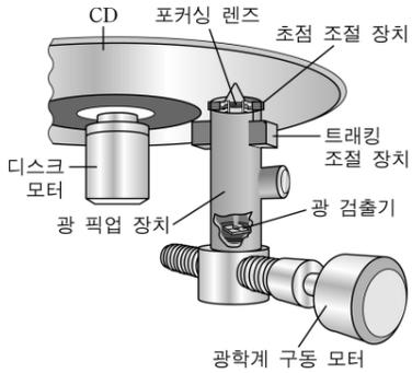
CD의 고속 회전 등으로 진동이 생기면 광선의 위치가 트랙을 벗어나거나 초점이 맞지 않아 데이터를 잘못 읽을 수 있다. 이를 막으려면 트래킹 조절 장치와 초점 조절 장치를 제어해 실시간으로 편차를 보정해야 한다. 편차 보정에는 광 검출기가 사용된다. 광 검출기는 가운데를 기준으로 전후좌우의 네 영역으로 분할되어 있는데, 트랙의 방향과 같은 방향으로 전후 영역이, 직각 방향으로 좌우 영역이 배치되어 있다. 이때 각 영역에 조사되는 빛의 양이 많아지면 그 영역의 출력값도 커지며 네 영역의 출력값의 합을 통해 피트와 랜드를 구별한다.
